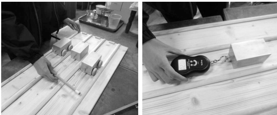
4. kép. A gördülés bemutatása, illetve az egységnyi tömegű test súrlódási együtthatójának meghatározása erőmérővel
