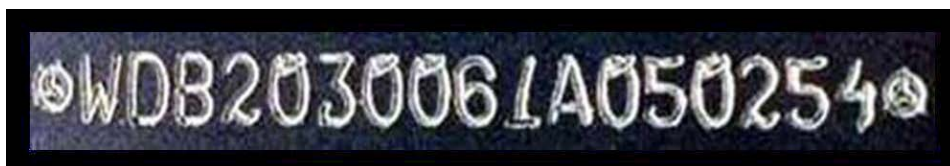
7. kép. Alvázszám felvitele véséssel
