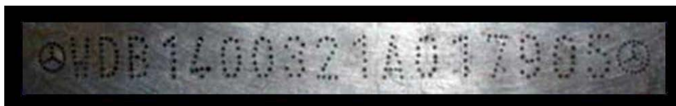
6. kép. Alvázszám felvitele lézerrel
