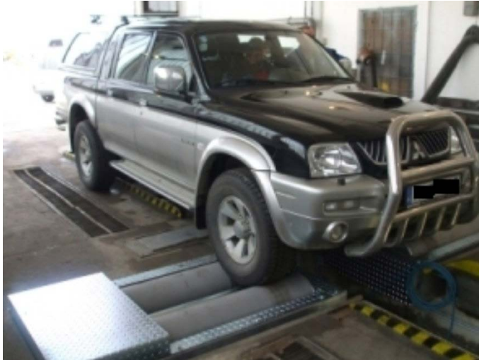
2. kép. A gépjármű mérése a fékpadon
